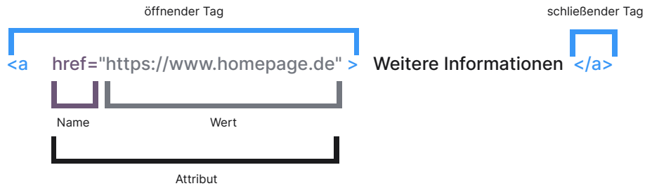
Abbildung 4 ► Aufbau eines HTML-Elements
